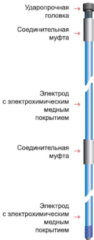
Рис. 22. Устройство штырьевого заземлителя.
